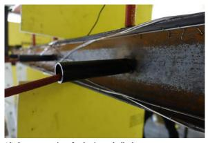
(d) Instrumentation for horizontal displacement measurement
